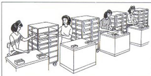
Figura 120a. Linha de montagem com estoques intermediários.
