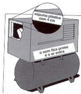
Figura 88c. Uma espessura de chapa de 1,5 mm reduz as vibrações.
